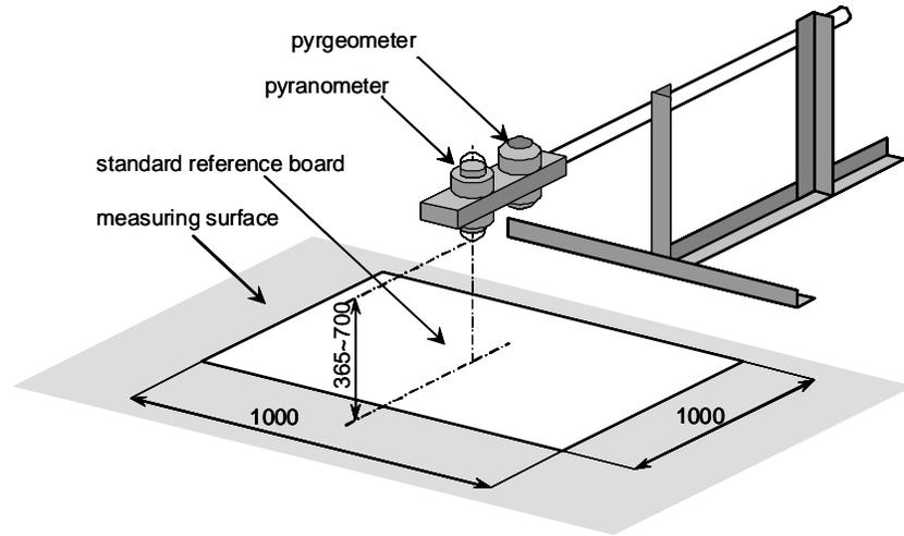
**Figure 1. Measurement apparatus**
